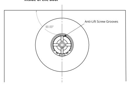
BE SURE THAT THE "ANTI-LIFT" SCREW GROOVES IN THE CENTER OF THE ROLLER -- AS VIEWED FROM THE INSIDE--ARE PERPENDICULAR TO THE EDGE OF THE GLASS.
